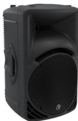
Mackie SRM450v3 cassa acustica attiva. Potenza: picco 1000W. Risposta in frequenza: (-3 dB) 55 Hz - 20 kHz, (-10 dB) 50 Hz - 23 kHz. Picco massimo SPL: 126 dB. Punto di crossover: 3 kHz. Tweeter da 1,4' con diaframma in titanio. Woofers da 12' con magneti in ferrite. 2 canali Ingressi XLR bilanciati, jack 1/4' Wide-Z, RCA. Limiter e protezione termica. Dimensioni: altezza 663 x larghezza 406 x profondità 376. Peso: 16,8 kg.
