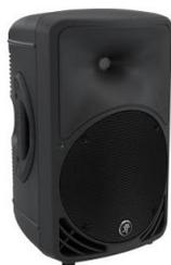
Mackie SRM350v3 cassa acustica attiva. Potenza: picco 1000W. Risposta in frequenza: (-3 dB) 47 Hz - 20 kHz, (-10 dB) 42 Hz - 23 kHz. Picco massimo SPL: 126 dB. Punto di crossover: 3 kHz. Tweeter da 1,4' con diaframma in titanio. Woofers da 10' con magneti in ferrite. 2 canali Ingressi XLR bilanciati, jack 1/4' Wide-Z, RCA. Limiter e protezione termica. Dimensioni: altezza 527 x larghezza 333 x profondità 311. Peso: 10,4 Kg.
