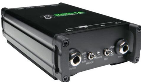
l'Perfetta per strumenti live come chitarre e bassi, dotati di pickup attivi e preamp, l'MDB-1A Active DI garantisce un'eccellente headroom e un funzionamento senza distorsione. Equipaggiata con un ingresso ad alta impedenza da 1/4" e un pad a -20 dbcon interruttore Merge che converte il Thru jack in un secondo input, perfetta per convertire la sorgente stereo in un output mono. L'uscita bilanciata XLR è equipaggiata con switch Polarity, Low Cut e Ground Lift. Alimentazione Phantom Power a 48v.
