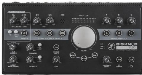
Controller professionale per monitor 4x3, 4 fonti x 3 coppie di monitor. Interfaccia audio USB 2x2 con preamplificatori Onyx e Phantom power. Qualità di registrazione 192 kHz e 24 bit.
