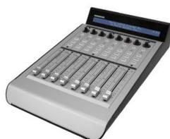
Estensione con otto fader per la superficie di controllo MCU Pro. Protocollo di comunicazione proprietario Mackie. Fader motorizzati 100 mm Penny & Giles crossfader ottici sensibili al tatto. V-Pot multifunzione per il controllo degli effetti panoramici ed altri. Tasti disattivazione audio, Solo, Pan, in via e registrazione per canale. Schermo retroilluminato con nomi di tracce e parametri.
