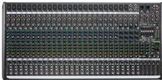
Mixer professionale con 30 canali e quattro bus. 24 preamplificatori microfonici Mackie VITA Class-A. Processore ReadyFX con 16 effetti di alta qualità. Compressore per canale. Equalizzatore grafico a 7 bande. 4 uscite ausiliarie. Interfaccia USB integrata. Dimensioni: 211 x 950 x 531 mm. Peso: 15,4 Kg.
