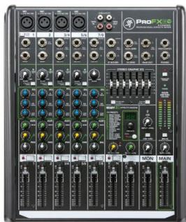
Mixer professionale a 8 canali con 4 preamplificatori microfonici Mita VITA Class-A. Processore ReadyFX con 16 effetti di alta qualità. Equalizzatore grafico a 7 bande. 2 uscite ausiliarie. Interfaccia USB integrata. Dimensioni: 178 x 396 x 455 mm. Peso: 4,5 Kg.
