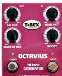
Pedale con funzione di ottava OCTAVIUS. Aggiunge 2 ottave (inferiore e superiore) al segnale originale. Comando di mixaggio. Funzione boost per extra di guadagno.
