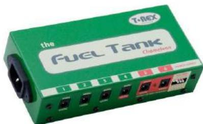
alimentatore FUELTANK CHAMELEON. 5 uscite con 300 mA ciascuna, divise in 3 blocchi isolati. 3 delle uscite selezionabili 9 V/12 V CC, 1 delle uscite selezionabili 9 V/18 V CC, 1 delle uscite selezionabili 12 V CA / 12 V CC.
