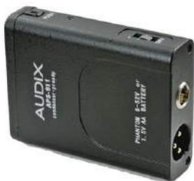
Adattatore di alimentazione phantom opzionale per microfoni a condensatore elettreti utilizzando con. Funziona con batterie AA Quando l'alimentazione phantom non è disponibile. Caratteristiche interruttore on / off e filtro roll-off dei bassi. I connettori sono standard di XLR-m a mini XLR-m. Inclusi con i modelli ADX10FLP e HT5BG. Può essere usato con ADX20iP, ADX40, ADX60, f90, MICROD o MicroHP.
