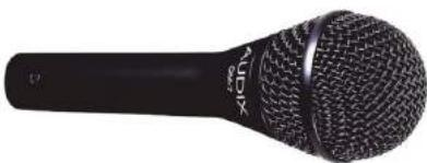
Microfono dinamico di diagramma polare Ipercardioide per voce. L'OM7 è noto per la sua capacità di fornire un guadagno senza precedenti prima del feedback in concerto senza sacrificare la qualità del suono. Per raggiungere queste prestazioni straordinarie, il OM7 è stato progettato con un non-convenzionale basso livello di uscita (8-10 dB inferiore ai tipici microfoni dinamici). Questo basso livello agisce come un "pad" naturale a capsula al fine di mantenere alta fedeltà alla fonte.
